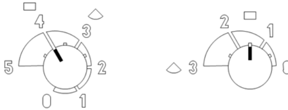
Abbildung 13 – links: Primärluftregler, rechts: Sekundärluftregler
